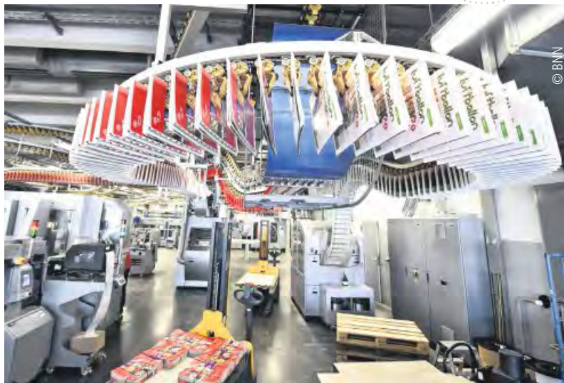
Gedruckt, geheftet und beschnitten wird der Luftballon nun gebündelt und geht in den Versand.
